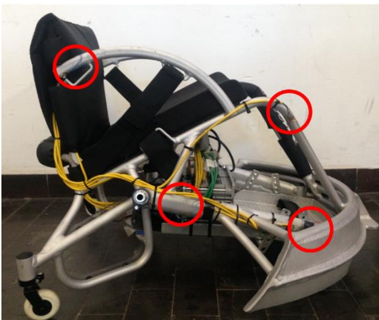
La carrozzina sensorizzata con il sistema di sensori applicato
